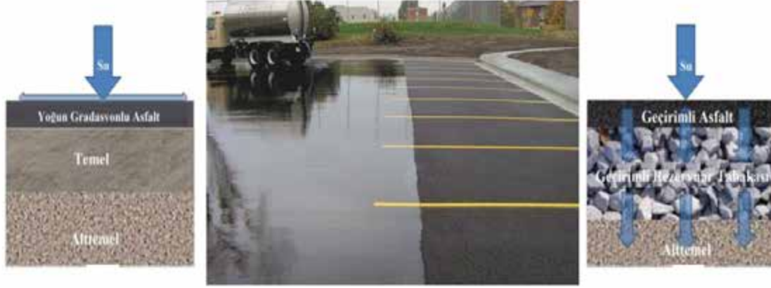
Şekil 2. Geleneksel ve geçirimli asfalt yüzeylerde drenaj (Topaloğlu, 2019)
