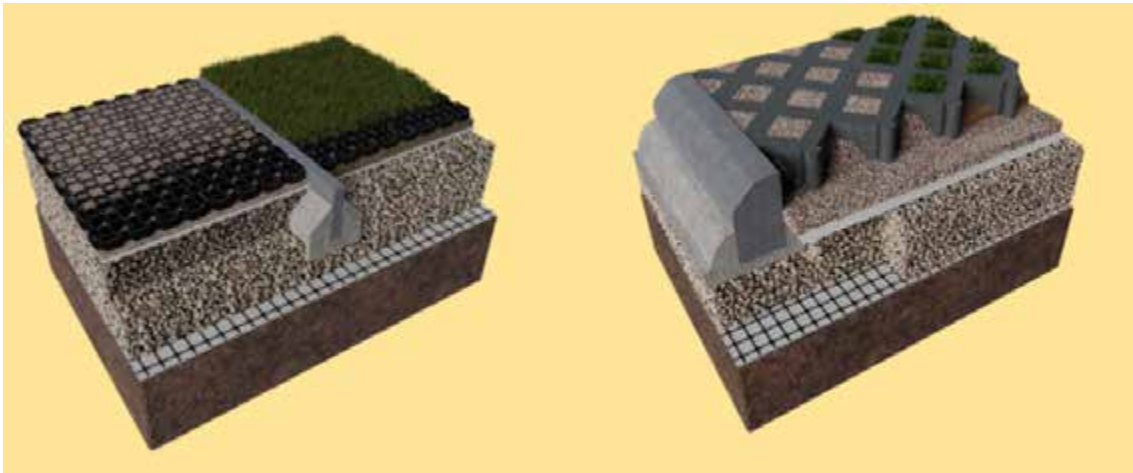
Şekil 4. Ekilebilir ve dolgu malzemeli plastik ve beton zemin güçlendirme ızgaraları kesiti (URL 8)
